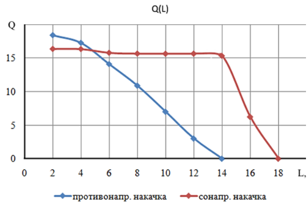
Рис. 5. Зависимость коэффициента качества от длины эрбиевого волокна ( P_n = 10 мВт, \lambda_n = 980 нм, \lambda_c = 1550 нм)
