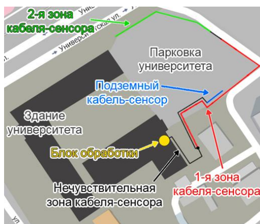
Рис. 1 Схема расположения кабель-сенсора при проведении исследований
