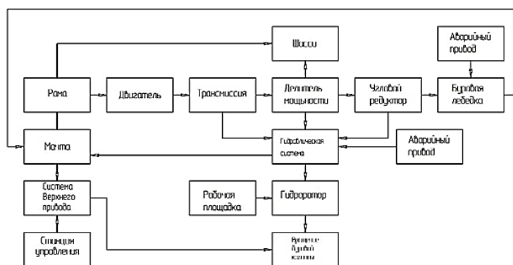
Рис. 1. Структурная схема надежности
