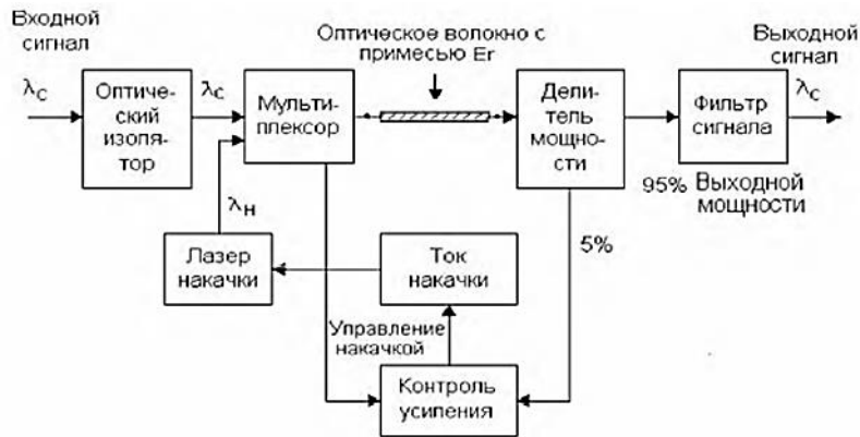
Рис.1. Функциональная схема эрбиевого ВОУ
