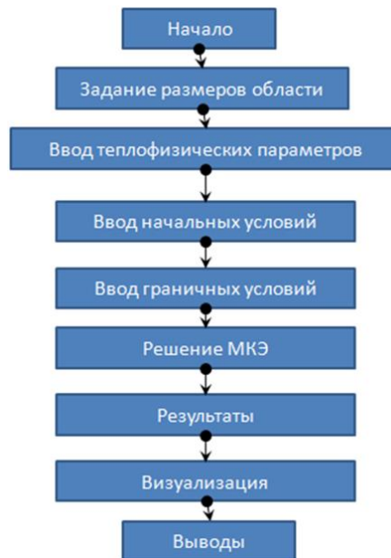
Рис. 1. Блок-схема алгоритма расчета электромагнитного нагрева пласта
