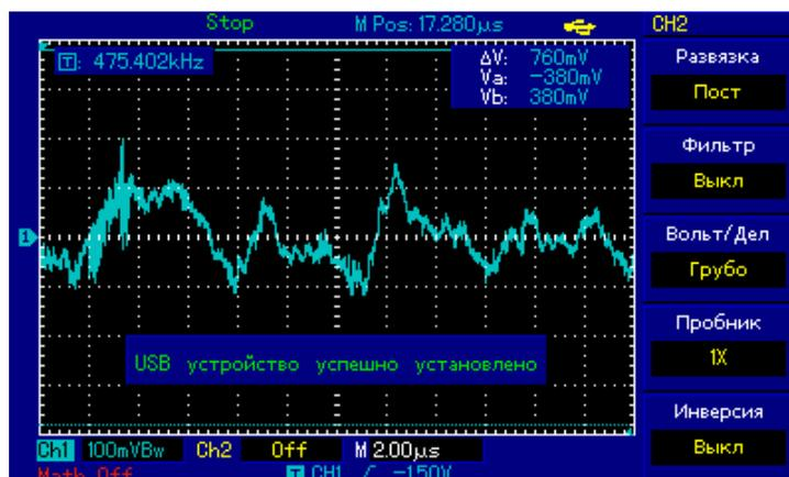
Рис. 1. Сигнал с выхода датчика пульса Pulse Sensor
