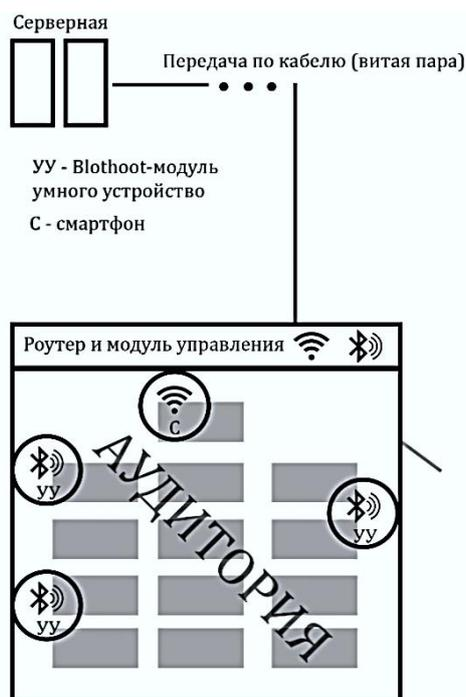
Рис. 4. Схема передачи информации в «умной аудитории»
