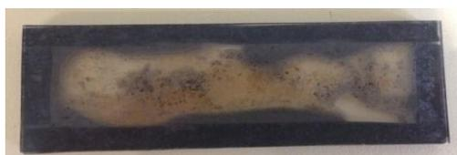
Рис. 1. Пробоподготовка образца бурового шлама
