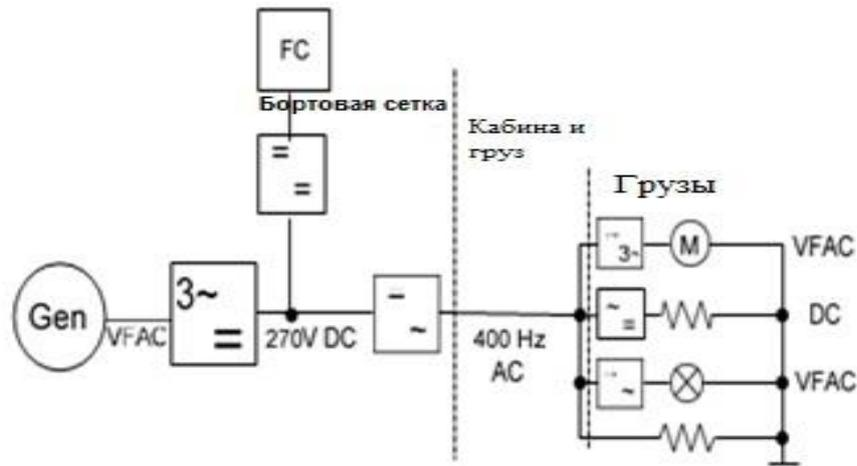
Рис. 3. Преобразователи в современной авиационной системе электропитания с обычными салонными и грузовыми грузами [2]
