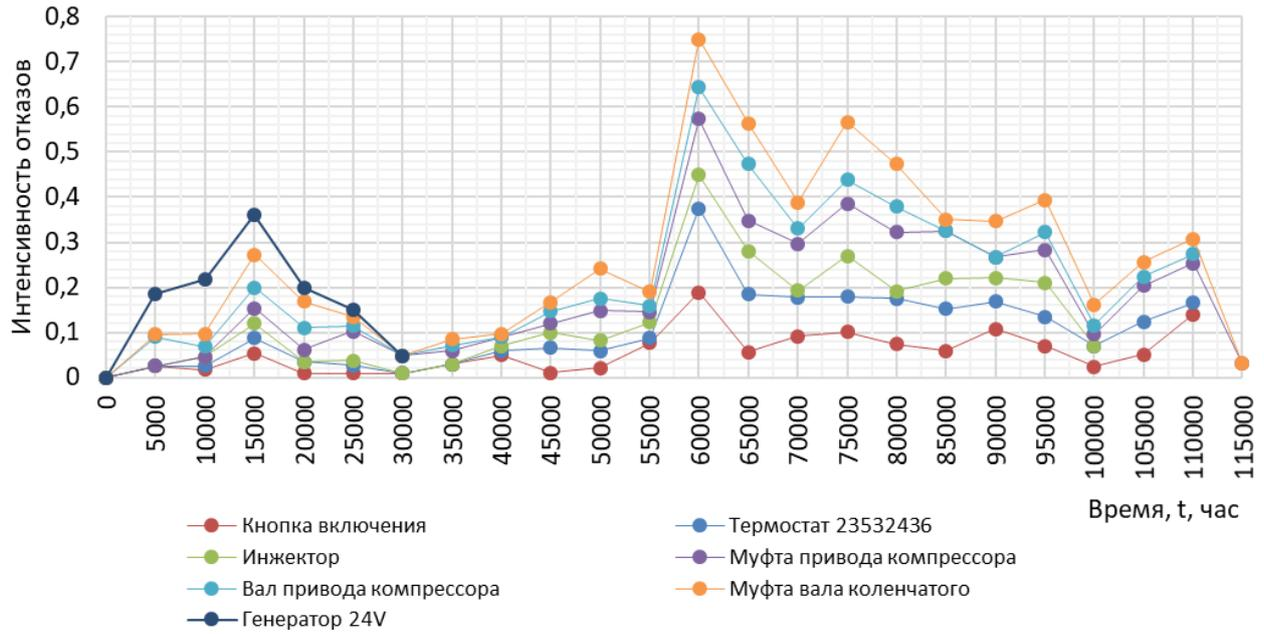
Рис. 2. Интенсивность отказов ЭЛЕМЕНТОВ двигателя ПА КВ-210
