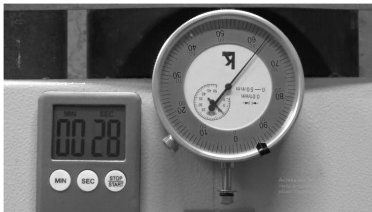
Рис. 1. Фиксация продольных деформаций и времени нагружения
