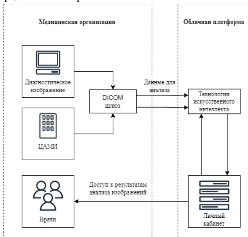
Рис. 2. Обобщенный принцип работы СППВР использующую облачную платформу.
