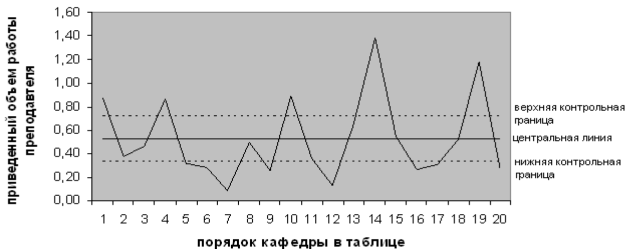
Рис.3. Пример контрольной карты, когда процесс не находится под контролем
