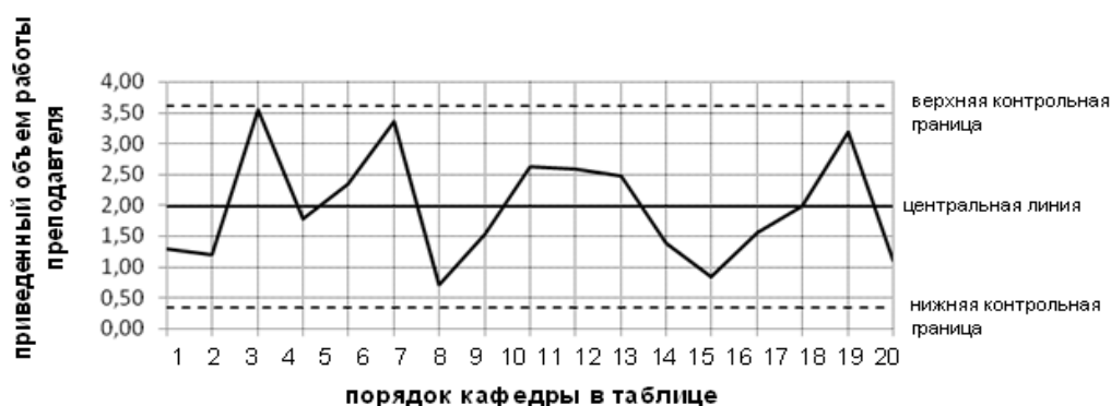
Рис.2. Пример контрольной карты, когда процесс находится под контролем
